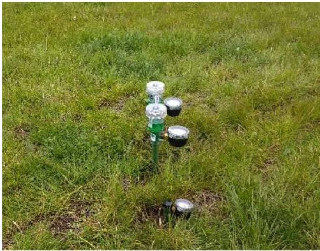
**Figura 2.** Tensiómetros instalados a diferentes profundidades del suelo.
