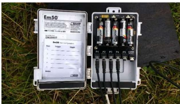
**Figura 8.** Almacenador de datos (data logger) al que se conectan los sensores.
