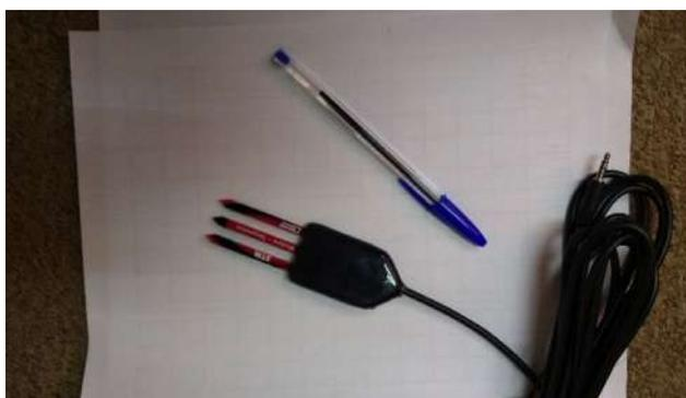
**Figura 7.** Sensor de humedad y temperatura de suelo.
