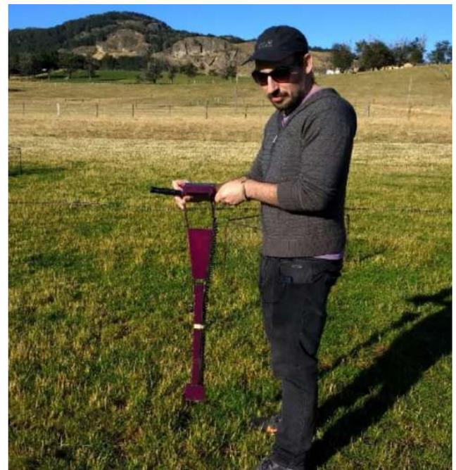
**Figura 5.** Medición de humedad del suelo mediante instrumento TDR.
