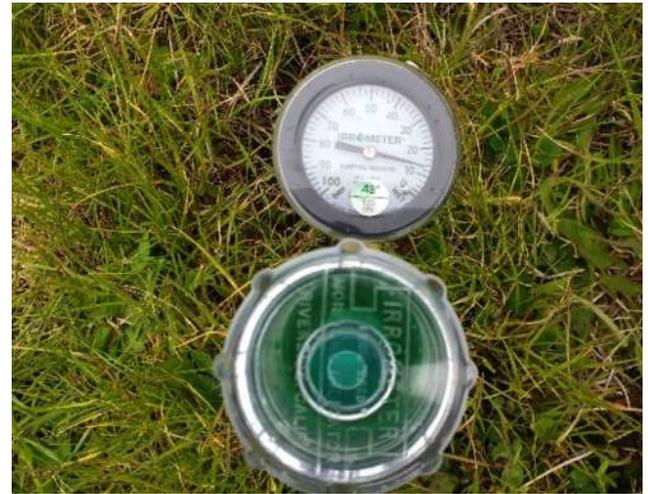
**Figura 4.** Tensiómetro y su vacuómetro, que muestra el estado hídrico del suelo.
