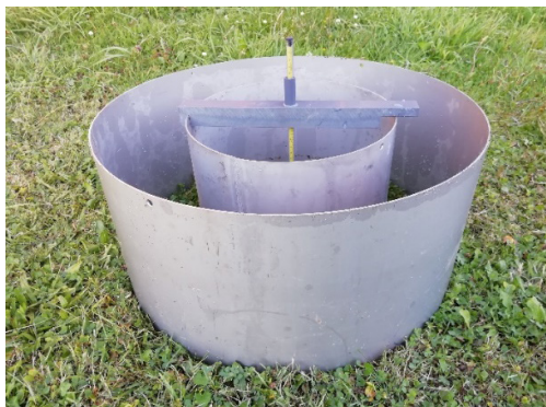
Figura 3.19. Infiltrómetro de doble anillo.
