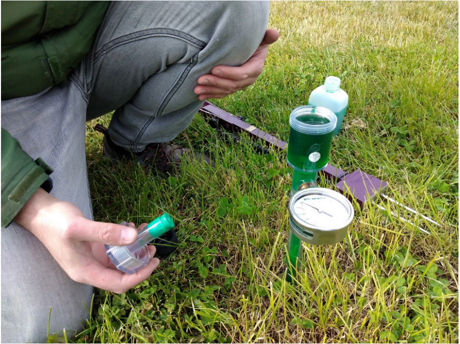
Figura 2.21. Uso de tensiómetros para monitorear el estado hídrico de suelo.
