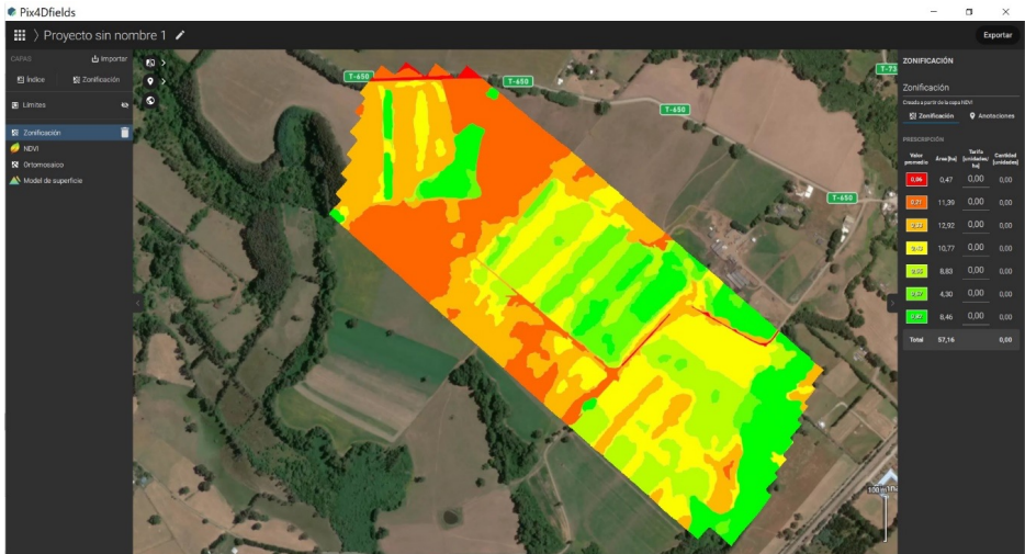
Figura 6.11. Mapa de NDVI, indicando problemas de uniformidad de riego de sistema de Carrete.
