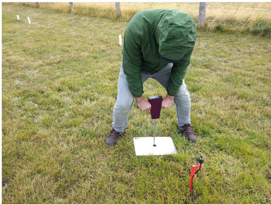
Figura 2.17. Uso del penetrómetro para medir la compactación en el suelo.
