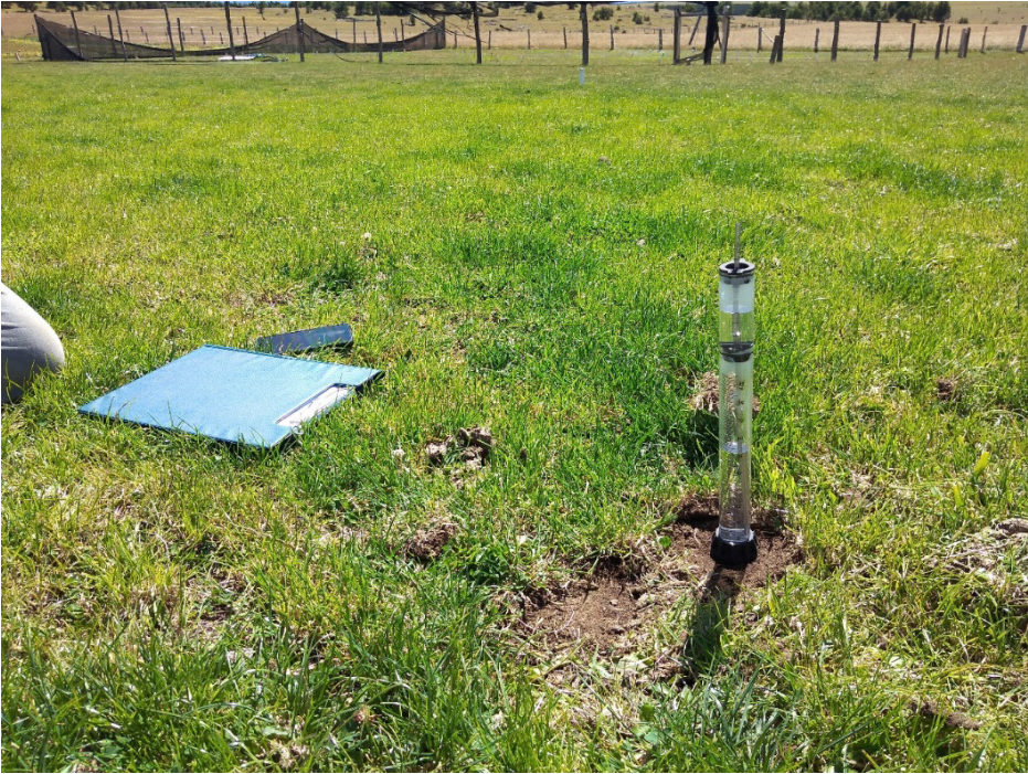
Figura 2.16. Minidisk para determinación de conductividad hidráulica.
