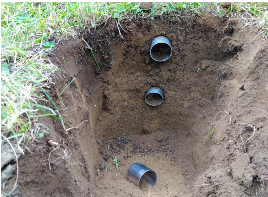
Figura 2.5. Calicata para la toma de muestra a diferentes profundidades con anillos metálicos.
