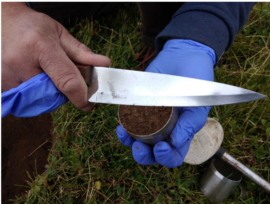
Figura 2.6. Preparación de la muestra para determinar densidad aparente.
