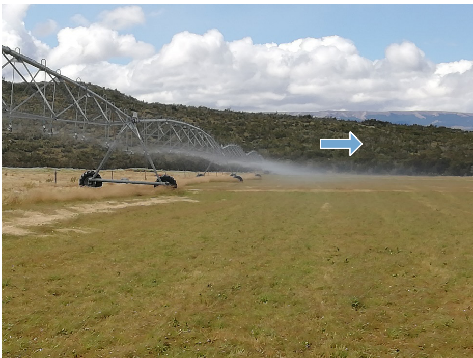
Figura 3.4. Efecto del viento en un riego por aspersión sistema de Pivote.
