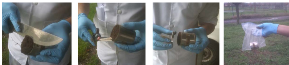
Figura 3.8. Toma de muestra con cilindro. Fuente: Laboratorio de Suelos INIA Quilamapu.
