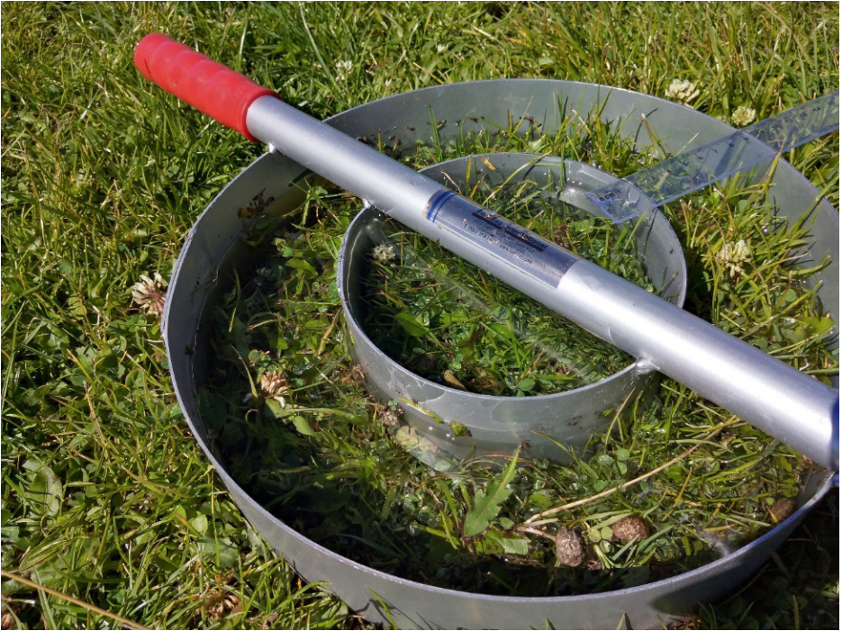
Figura 2.9. Medición de infiltración de agua en terreno (infiltrómetro de anillos).
