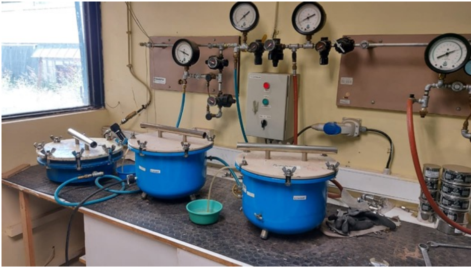
Figura 3.9. Instrumento de medición de tensión de humedad en el suelo. Fuente: INIA Quilamapu.
